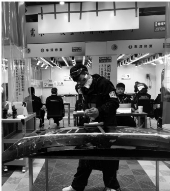
在比赛现场,范宇正在给一块受损车身外板进行车漆修复。
