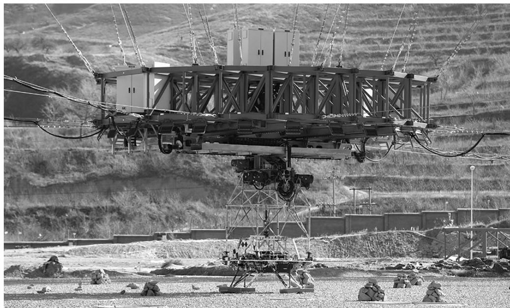
11月14日拍摄的试验现场。当日,我国首次火星探测任务着陆器悬停避障试验在位于河北省怀来县的地外天体着陆综合试验场圆满完成,此次试验是我国火星探测任务首次公开亮相,试验模拟了着陆器在火星环境下悬停、避障、缓速下降的过程,对其设计正确性进行了综合验证。
