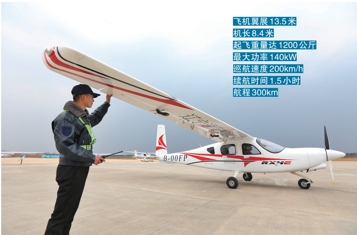
飞机采用上单翼、低平尾、前置螺旋桨、前三点式不可收放起落架的布局形式。
