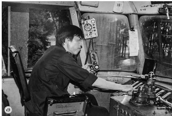
过去,火车司机用电话联系前方站确认进站股道和信号开放情况,依靠人工观察前方信号灯;现在,这些工作已被信号全自动采集系统替代。列车驾驶室操作台机械化控制被数字化控制所取代,司机的工作环境发生了巨大改变。
