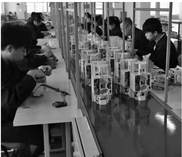
公司生产车间正在装配双电源自动转换开关。 采访对象供图
