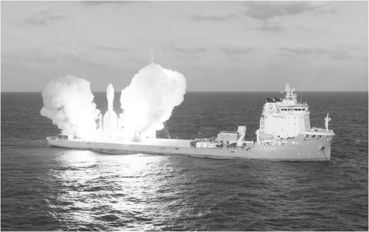
9月16日6时00分,我国太原卫星发射中心在上海东部海域使用引力一号遥三运载火箭,将搭载的千帆极轨26组卫星及EUHT技术试验卫星共9颗卫星顺利送入预定轨道,飞行试验任务取得圆满成功。记者从火箭研制方东方空间(山东)科技有限公司获悉,此次任务创下我国单次海上发射载荷重量和轨道高度新高,净载荷重量超3吨,入轨高度约800公里,验证了海上发射模式对中大型卫星载荷任务的适应能力。
