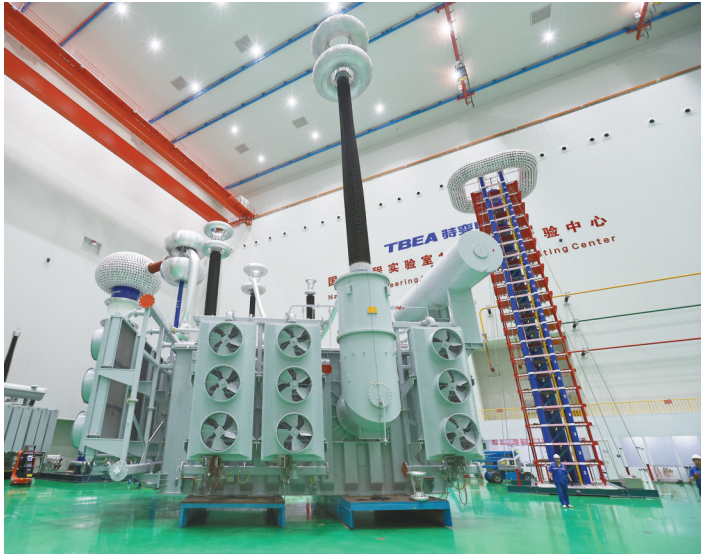
沈变公司自主研发的行业首台特高压高阻抗交流变压器。 沈变公司供图
