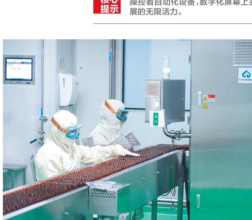
东北制药小容量注射剂生产线B正在灌封左卡尼汀注射液。
