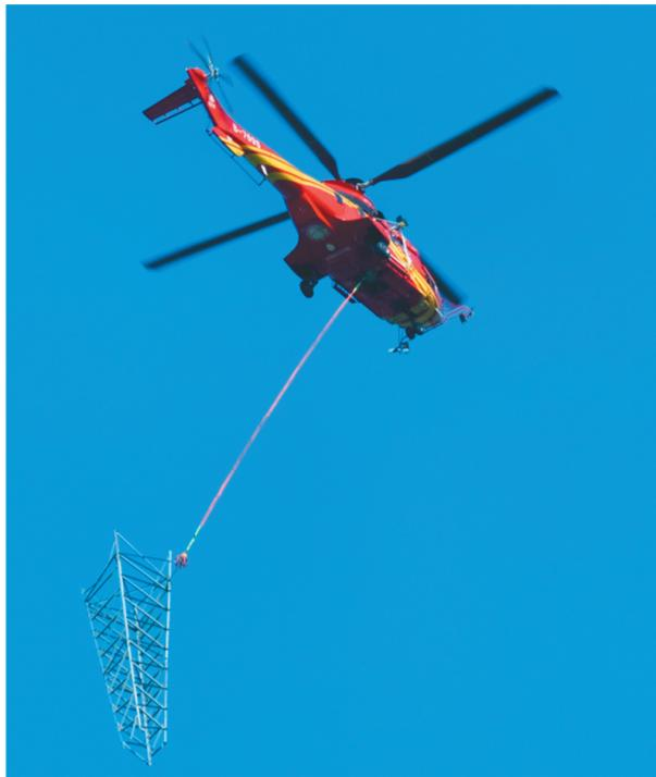
8月24日,在建昌县大屯镇,国网电力空间技术有限公司的直升机将倾倒在山梁上的电力铁塔吊起,运往新开辟的储料场。本报特约记者 杨兵 摄
