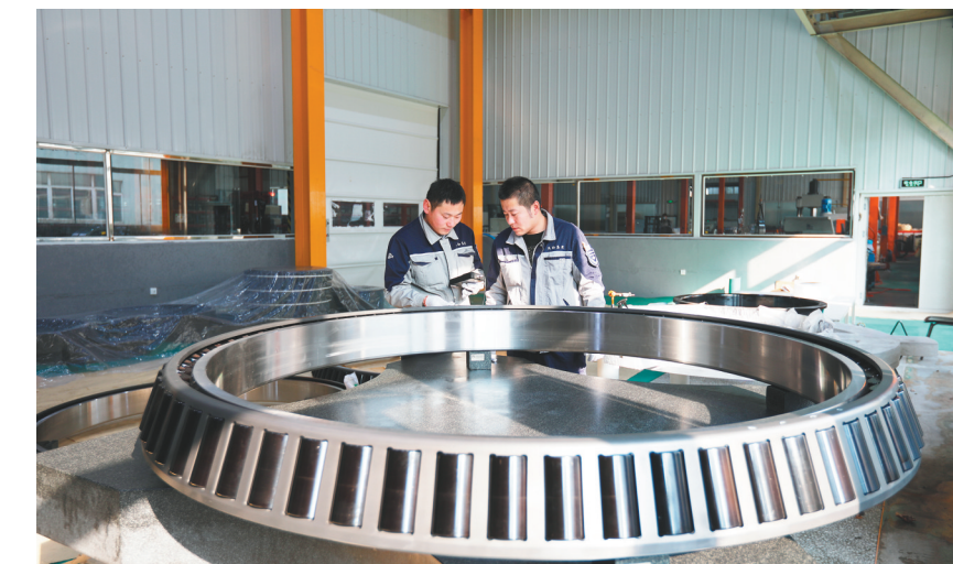
瓦轴集团风电主轴轴承装配现场。 鞠家田 摄
