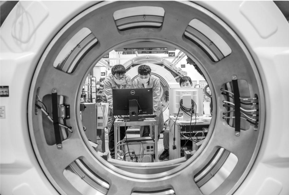
工人在位于辽宁省沈阳市的东软医疗系统股份有限公司生产车间生产CT机。
