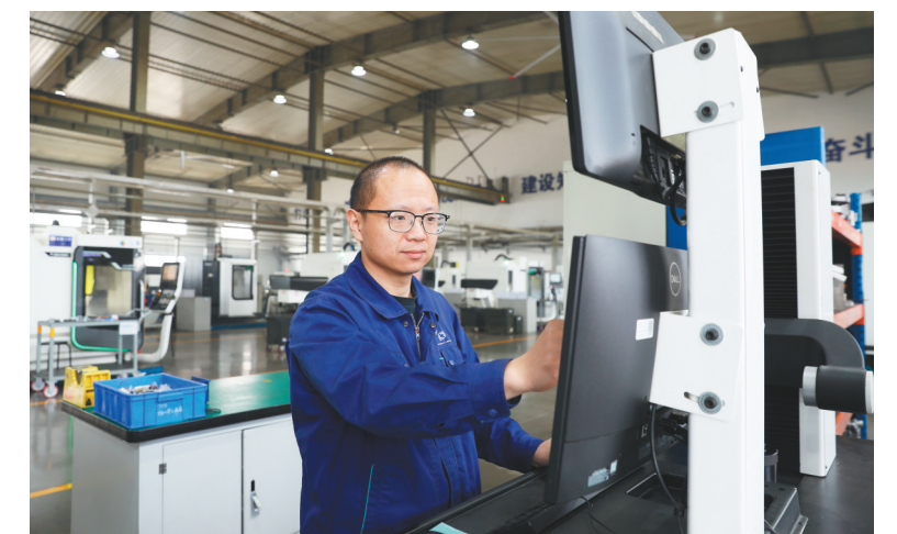
辽沈工业集团首席技师王巍正在进行刀具预调。
