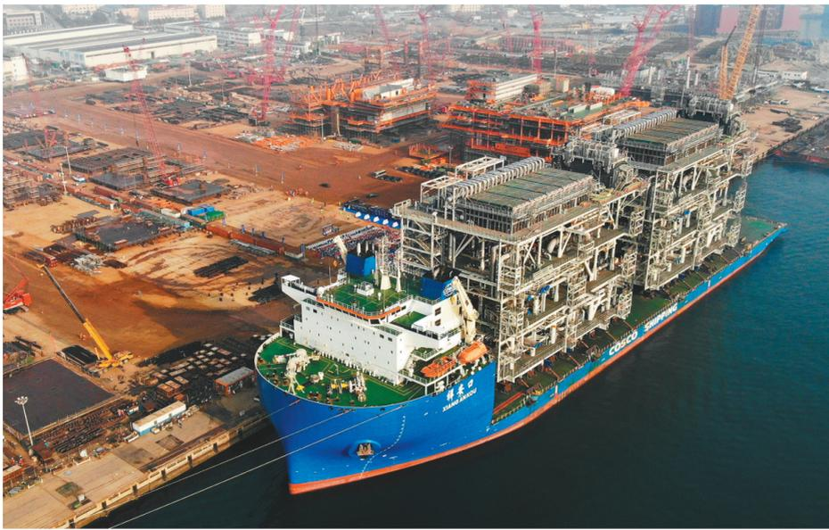
3月7日，加拿大LNG项目最后两个核心工艺模块在青岛场地装船(无人机照片)。
