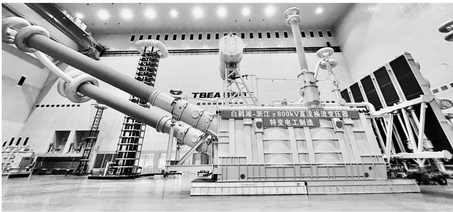
图为用于“白浙工程”的换流变压器首次采用国产±800kV干式直流套管。
