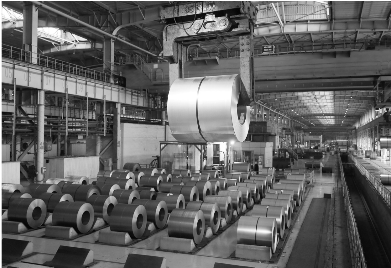
图为在本钢冷轧厂,吊车在吊装钢卷。
