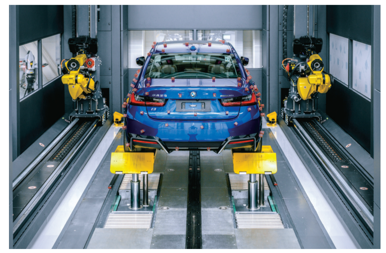
“精益”的几何光学测量系统(GOM)对零部件及整车进行完整的扫描。
