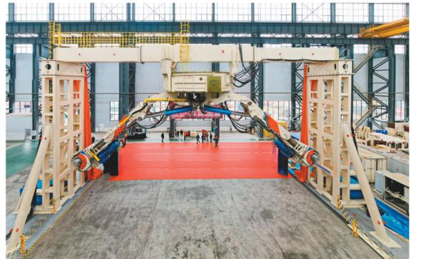
这是11月29日在长沙拍摄的“梦想号”竖井掘进机(无人机照片)。当日,由我国自主研发的超大直径竖井掘进机“梦想号”在长沙下线。“梦想号”整机高约10米,开挖直径达23.02米,标志着我国地下空间领域工程装备科技攻关及应用又上新台阶。新华社记者 陈思汗 摄
