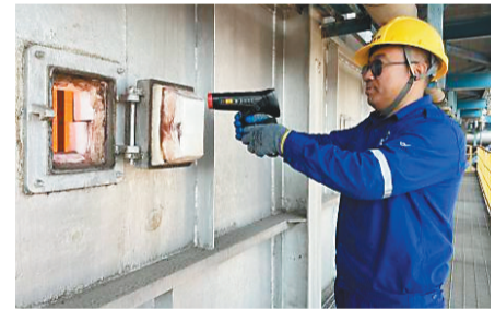
赵立华在高温的工作环境下,监测炉管温度采集数据。
