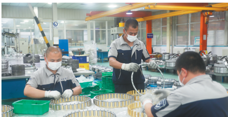
瓦轴集团生产车间内,工人正在装配传动轴承。
