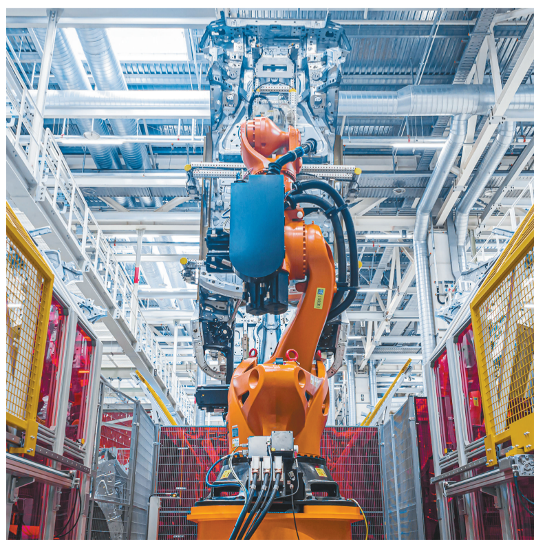
库卡最大的TITAN机器人能够灵巧抓取下车身。
