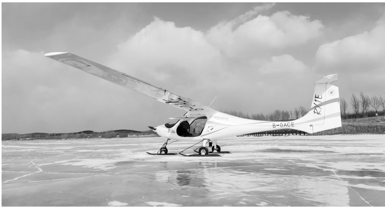
图为国内首款冰雪型双座电动飞机(验证机)在冰雪环境下试飞现场。
