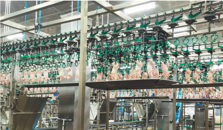
北票市宏发食品有限公司荷兰梅恩肉鸡自动化加工生产线。
