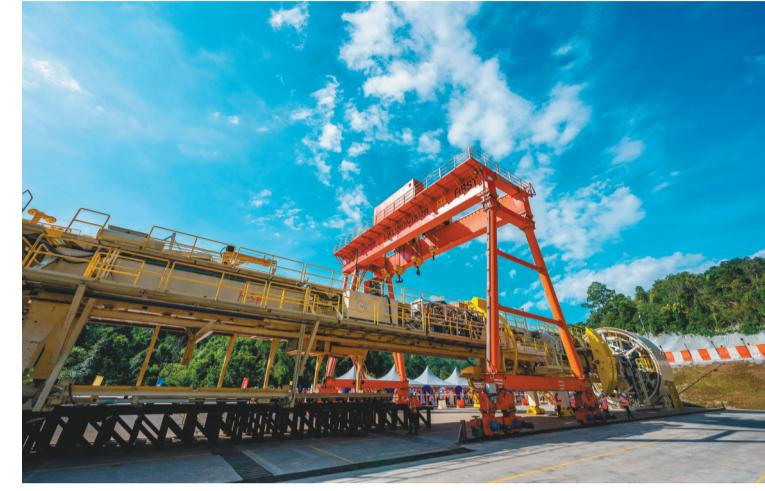
这是1月13日在马来西亚彭亨州文冬附近的马来西亚东海岸铁路项目云顶隧道建设工地上拍摄的敞开式硬岩掘进机。马来西亚交通部长魏家祥近日表示,中方建设者拥有丰富的经验和技术知识,使马来西亚东海岸铁路项目建设受益。
