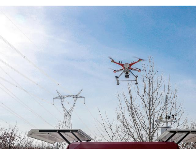
国网大连供电公司建设500千伏智慧线路,通过“线路全感知设备+无人机”自主巡检,实现立体化巡检。
