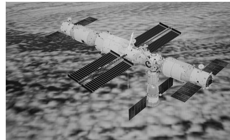
1月6日在北京航天飞行控制中心拍摄的空间站机械臂转位货运飞船试验,天舟二号货运飞船与天和核心舱重新对接并完成锁紧。 新华社发
