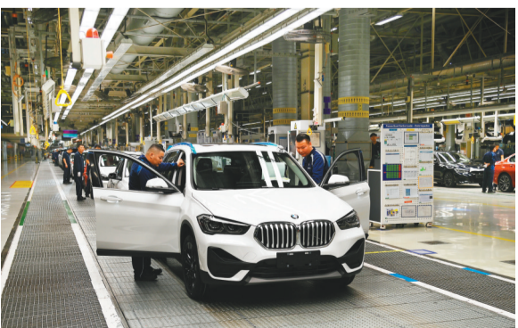
华晨宝马铁西工厂内,一辆辆新车正在组装等待下线。
