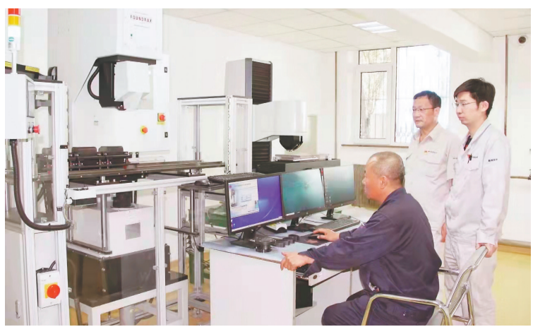
鞍钢股份质检中心工作人员操作自动布氏硬度计进行产品硬度检测。鞍钢集团供图
