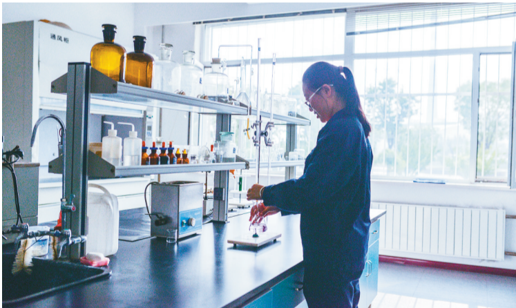
在辽宁鸿昊化学分析室里,技术人员正在对硼-10酸进行化学滴定。
