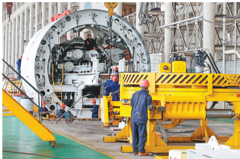
三三工业大型盾构机设备生产车间。
