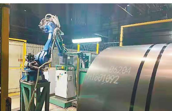
鞍钢冷轧厂三分厂连退机组自动贴号机器人正在作业。
