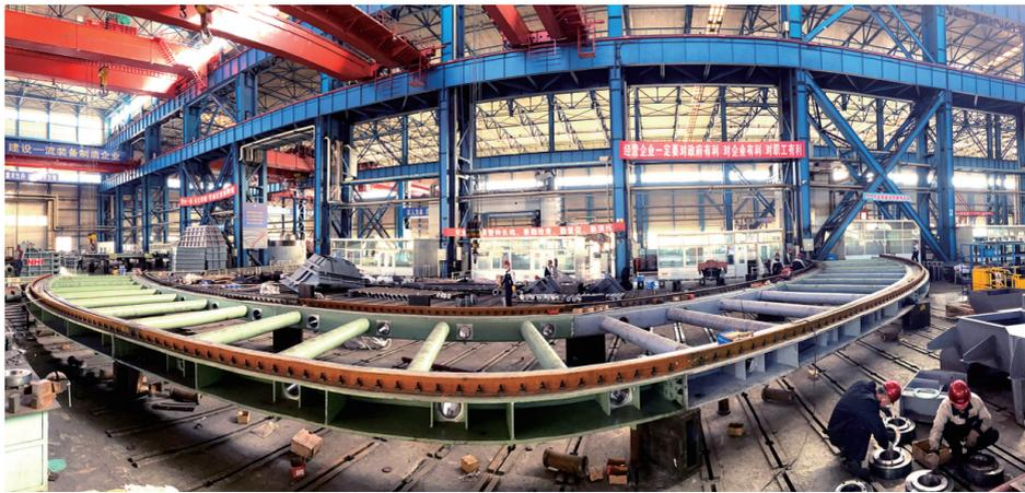
北方重工装配车间环冷机装配现场。(资料片)
