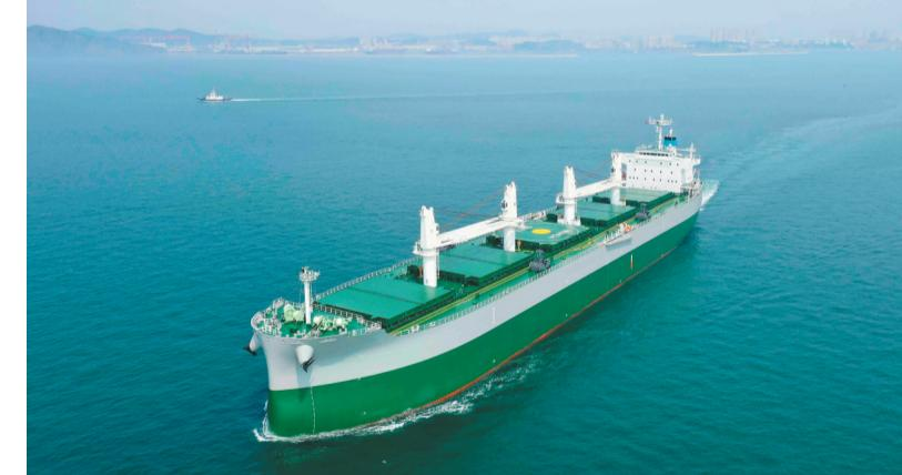
8月16日,在旅顺海关的监管下,大连中远海运川崎船舶工程有限公司制造的3艘6.1万吨散货船同时交付出口。本次交付的6.1万吨散货船船长199.90米,型深18.60米,设计航速15.8节,各项性能优异,是当今市场最受欢迎的散货船型之一。
