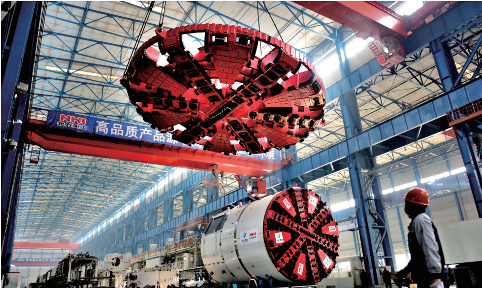
全断面掘进机正在北方重工厂房内装配。
