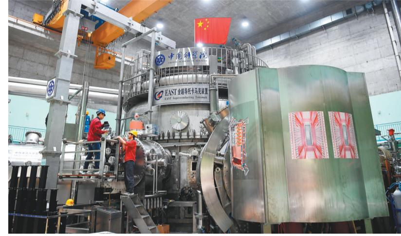
图为在中科院合肥物质科学研究院,工作人员对全超导托卡马克核聚变实验装置(EAST)进行升级改造(资料照片)。 新华社记者 刘军喜 摄
