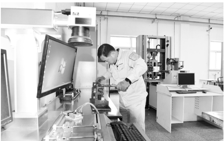
质计中心党总支书记、主任张永丰在进行拉伸实验前试样打点操作。
