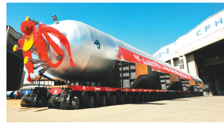
世界最大2400吨镇海沸床渣油加氢反应器。
