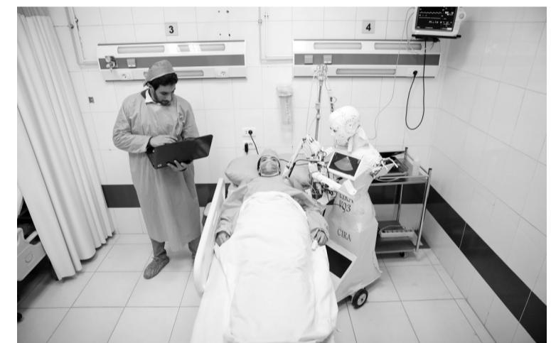
12月3日,在埃及坦塔的一所医院,Cira 03机器人对志愿者进行超声心动图检测。这台名叫Cira 03的遥控机器人由埃及工程师马哈茂德·科米开发,具备体温检测、新冠病毒的聚合酶链式反应(PCR)检测等功能,能够减少医务人员的感染风险。
