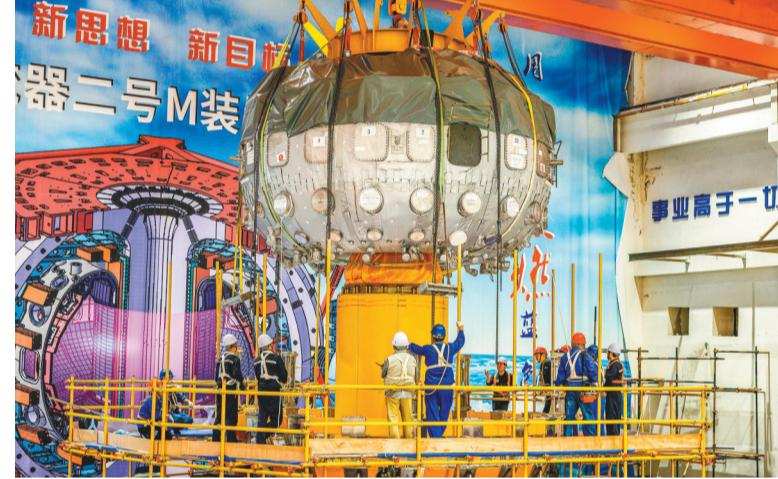
我国新一代可控核聚变研究装置“中国环流器二号M”（HL-2M）4日在成都正式建成放电，标志我国正式跨入全球可控核聚变研究前列，HL-2M将进一步加快人类探索未来能源的步伐。中核集团核工业西南物理研究院聚变科学所所长许敏介绍：“HL-2M是我国规模最大、参数最高的‘人造太阳’。”图为中核集团核工业西南物理研究院的工作人员在安装调试中环流器二号M装置时进行真空室吊装作业。
