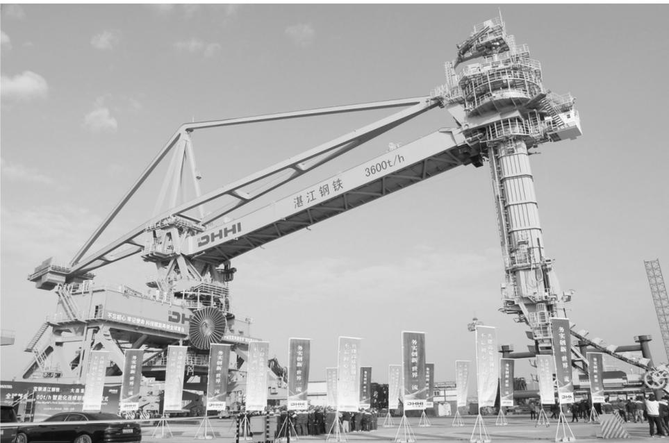
目前,大连重工已全面掌握大型智能无人化连续卸船机的研制技术,具备1200吨/小时至4200吨/小时智能无人化连续卸船机研制能力,可覆盖1万吨至40万吨级各类型散货船的装卸应用。
