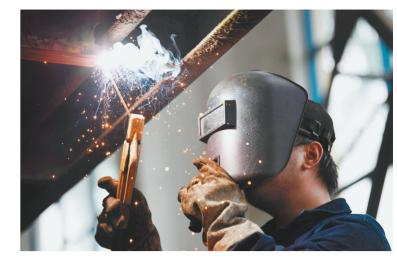
为保障暑运期间铁路车辆运行安全,中国铁路南宁局集团有限公司南 宁车辆段近期对普速客车进行检修。检修车间内的电焊工人犹如一个个 "蒙面火枪手",他们冒着高温,在三伏天里对火车车体外墙板、车底横梁、 车底板进行作业。图为电焊工人在作业中。 新华社记者 周华 摄
