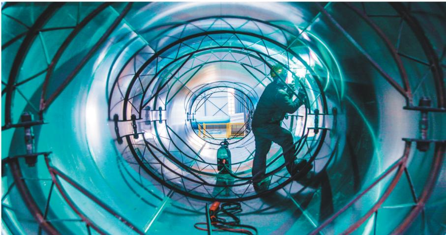
辽宁沈阳金豪装备制造有限公司员工进行油罐车罐体焊接作业。
