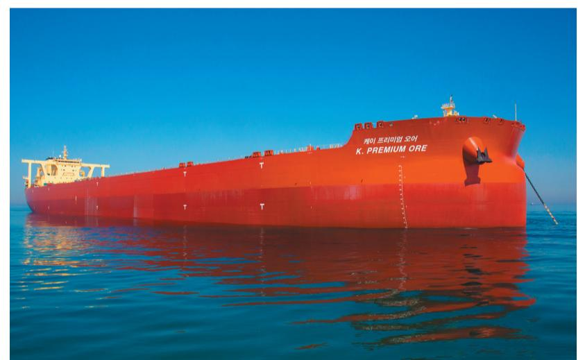
大船集团为韩国SK海运公司建造的32.5万吨级“富矿号”矿砂船日前正式交付使用。32.5万吨矿砂船9号船(B300K-9)是大船集团建造的第二艘超大型矿砂船，船长339.9米、型宽62米、型深29.5米、载重量32.5万吨。全船压载系统管系采用玻璃钢材质，配置有排气硫氧化物洗涤装置，设有LNG燃料预留舱，环保节能、安全坚固，总体性能达到世界领先水平。
