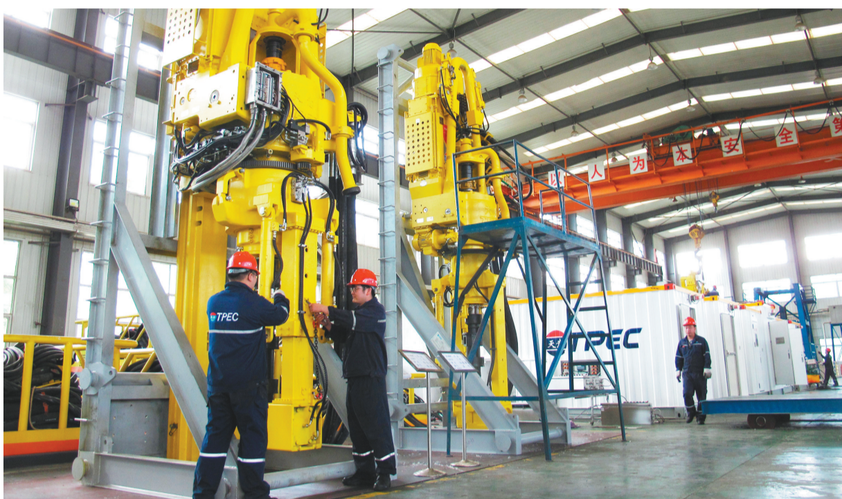
技术人员正对顶驱装置做综合功能调试及负载试验。
