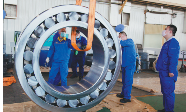
图为装配工序操作者组装轴承。 鞠家田 本报记者 杨丽娟 摄
