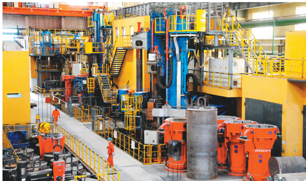
抚顺特钢三炼钢新电渣炉厂的国内首台15吨压力电渣炉正在冶炼高温合金产品。 本报记者 崔振波 摄
