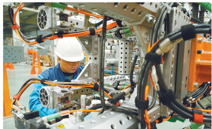
大连奥托股份有限公司员工为客户装配汽车白车身生产线。
