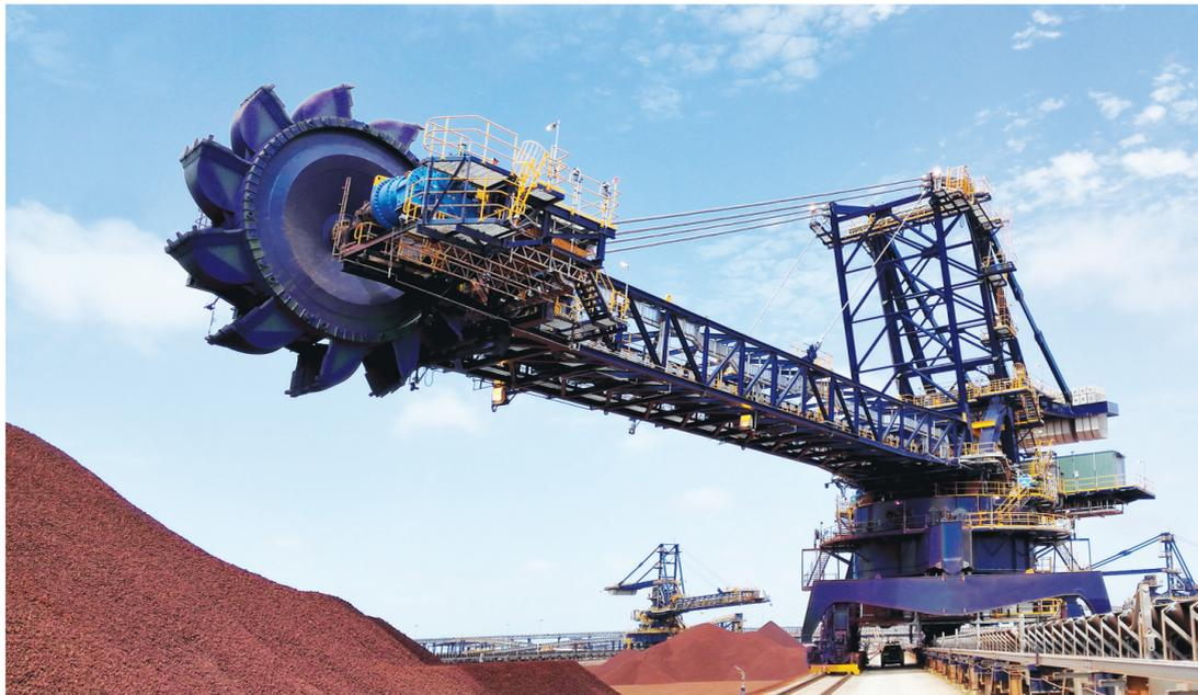
大连重工采用国际最高标准研制的出口澳大利亚罗伊山公司的1.44万吨/时堆取料机。(资料片)
