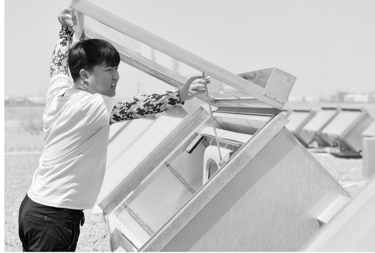
图为检测员尤里武在车体内部环境模拟试验箱前进行样品投试。试验箱内部温度达70℃以上。
