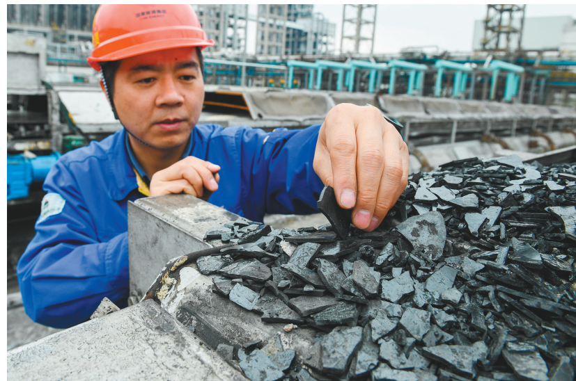
图为一名工作人员在国家能源集团鄂尔多斯煤制油分公司查看煤直接液化产生的副产品沥青。 新华社记者 刘磊 摄
