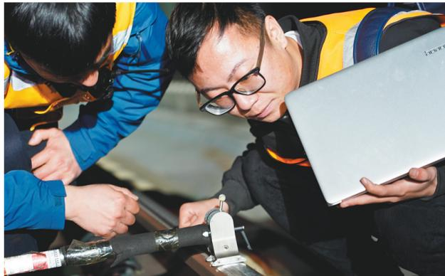
打磨完成后,技术人员认真检测打磨过的钢轨是否达到要求。
