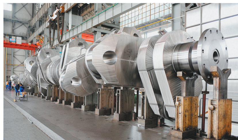
图为全球首支、世界最大的22000标箱集装箱船用曲轴。 本报记者 王刚 摄
